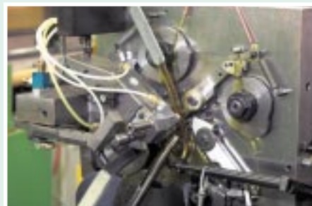
我々のハイスピード削出し装置は1.3億本/週のピンを生産しています。これがPRECI-DIPが世界のマーケットリーダーの一員たる所以です。
